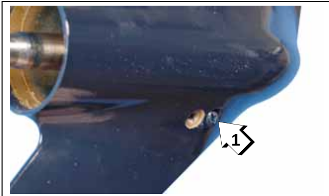
1. Shift lever pivot pin
