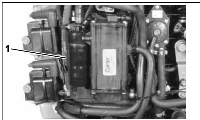
Vapor Separator Assembly
